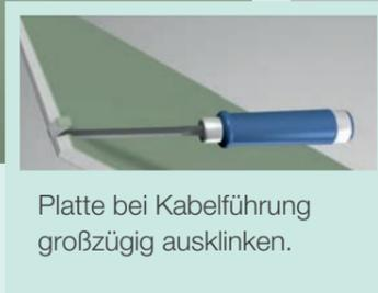
Platte bei Kabelführung großzügig ausklinken.
