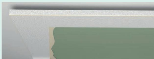
Anstrichvlies mit Spachtelmasse auf dem Übergang vom Profil zur Gipskartonplatte aufbringen. Bei Bedarf mehrmals wiederholen!
