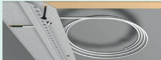
Einführen der Zuleitung für die Einspeisepunkte durch die erstellten Löcher ziehen. Profile an die Trockenbau-Konstruktion anbringen.
