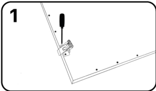
Montieren Sie 4 Federklammern auf der Rückseite der Panel.
