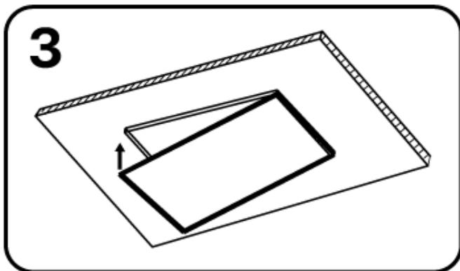
Schließen Sie den Treiber gemäß den mit dem Panel gelieferten Installationsanleitung an. Heben Sie die Federklammern an und drücken Sie die Panel nach oben.
