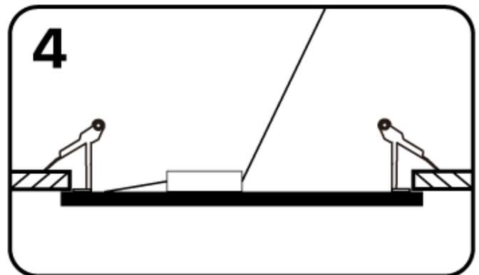
Lösen Sie die Federklammern, um die Panel sicher an der Zwischendecke zu befestigen.
