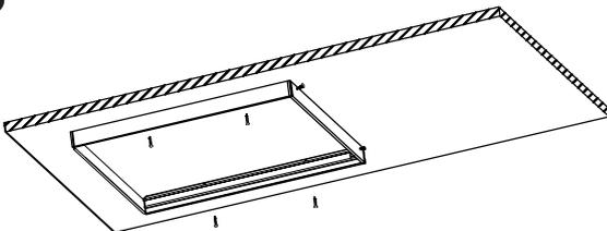
Schrauben Sie den Rahmen an die Decke. Lösen Sie das Kurzprofil. Schließen Sie die elektrischen Kabel an und platzieren Sie den Transformator auf der Rückseite des Panels.
