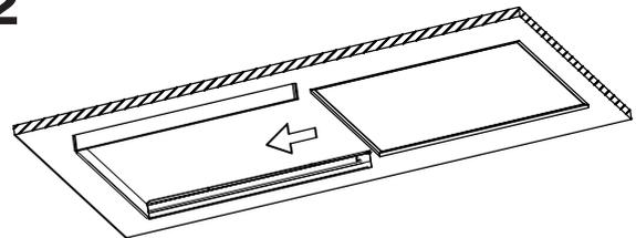
Befestigen Sie die Rahmen an der Decke und machen Sie Markierungen zum Bohren. Achten Sie auf die rechten Ecken des Rahmens!
