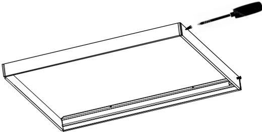
Legen Sie die Rahmenprofile auf den Tisch und verbinden Sie die Rahmenteile mit acht Schrauben. Schrauben an einer Schmalseite nicht zu fest anziehen!
