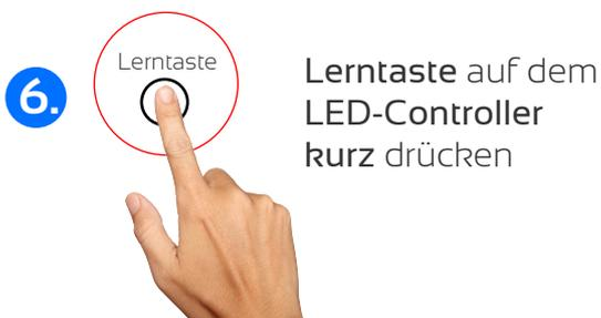
Zur Programmlöschung Lerntaste auf dem LED-Controller so lange drücken, bis das LED-Leuchtmittel blinkt.
