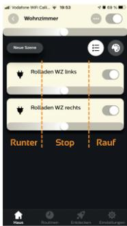
Beide Aktoren sind ~50% gedimmt. Sie liegen somit zwischen 30% und 70% was den Aktor (Motor) stoppt.
