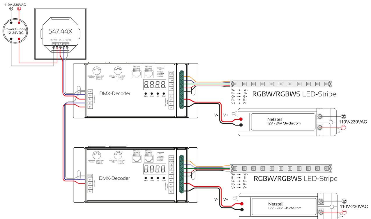
DMX ist ein Bussystem, je nach Gesamtlänge der Signalkabel kann es notwendig sein, einen Abschlusswiderstand am letzten DMX-Gerät in der Kette zu verwenden. Jeder DMX-Decoder muss auf die spezifischen Adressen eingestellt werden. Der Wand-Dimmer verwendet die DMX-Adressen 001-016 für die Farben Rot/Grün/Blau und Weiß in den vier Zonen. **Achtung:** für jede DMX-Kette darf nur **ein** DMX-Master (hier der Wand-Dimmer) verwendet werden.
